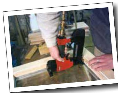
Equipé d'un dispositif de vitrage spécialement conçu pour la fixation de parclose en aveugle.
