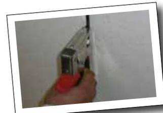
Agrafreuse spécialement conçue pour la pose de câbles de diamètre allant jusqu'à 6 mm.
