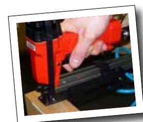
Appareil pour une grande précision d'agrafage pour l'emballage de cartons ondulés et pour la fermeture de couvercles.
